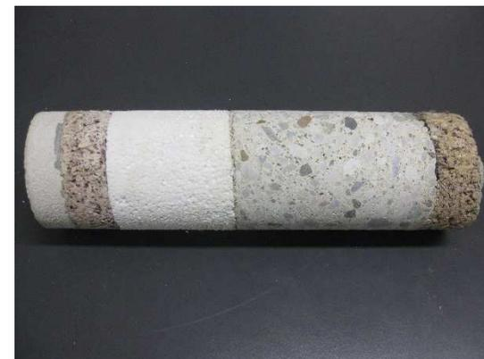
**Sezione di una parete ISOSPAN**
